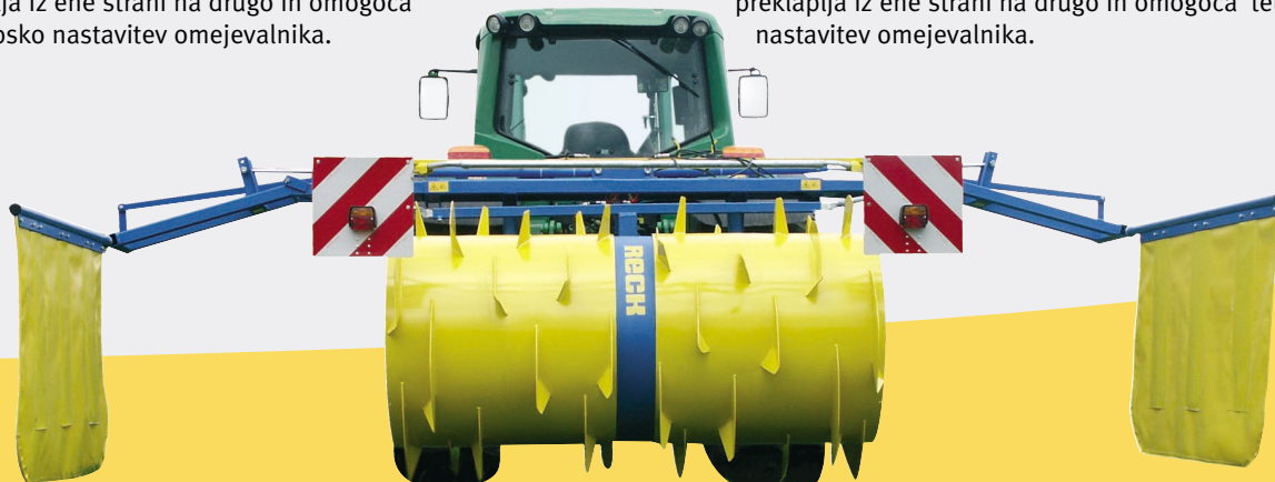
Na sliki: JUMBO JSV-NHS 223 z dodatno opremo JSV-PTH (hidravlični omejevalnik raztrosa s teleskopom)
